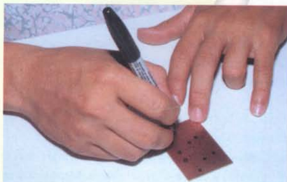
Figura 5.25. Haciendo los círculos sobre los puntos marcados
